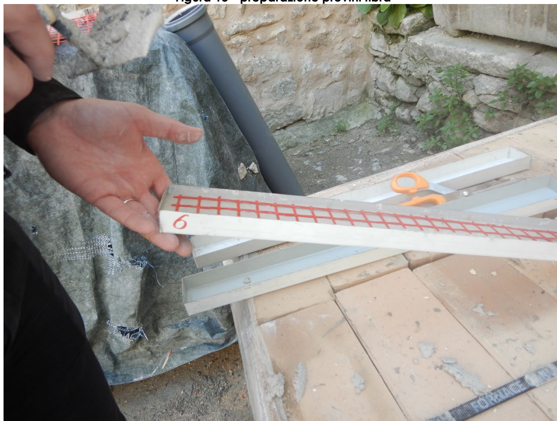
Figura 14 - preparazione provini fibra
