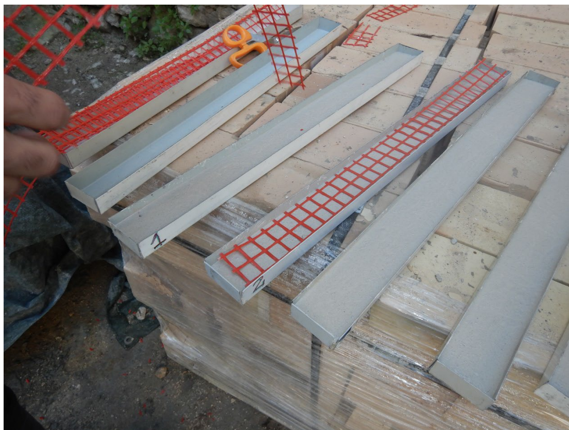
Figura 13 - preparazione provini fibra
